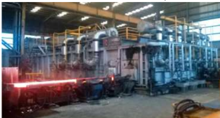
Fig. 1. Horno de calentamiento visto desde la puerta de descarga
