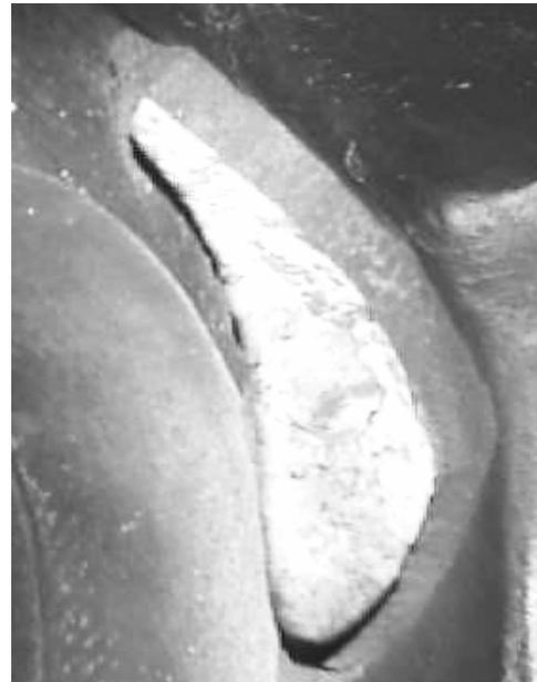
**Figura 2.** Vista de la zona averiada de la pared de agua.
